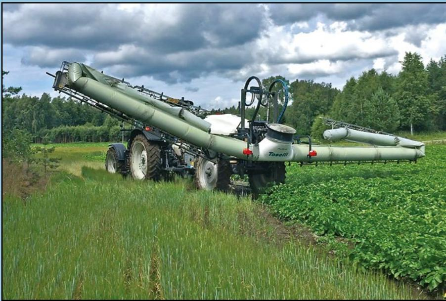
Le nostre barre con **stabilizzatore a trapezio deformabile** e **sospensioni idropneumatiche**, la **geometria variabile indipendente** ed il nuovo sistema di **livellamento elettronico automatico**, garantiscono prestazioni ottimali anche nelle peggiori condizioni di lavoro.
