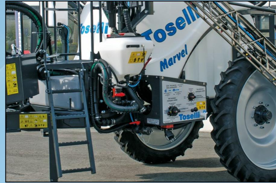
Marvel è stata progettata per assicurare **ergonomia e sicurezza** in ogni fase operativa; riempimento, preparazione miscela e lavaggio circuito vengono eseguiti a terra dalla medesima posizione, **accelerando le operazioni e diminuendo i rischi per l'operatore**.
