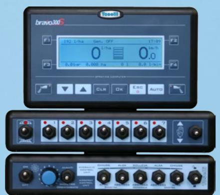
Le irroratrici Marvel sono equipaggiate con monitor multifunzionali per il controllo integrato della distribuzione, delle movimentazioni idrauliche e delle altre funzioni complementari
